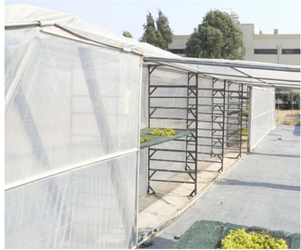
Şekil 2. Polietilen yüksek tünel tipi kurutucu Figure 2. Polythene tunnel solar drier
